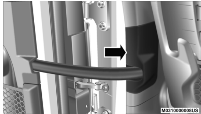
Wiring Access Door
